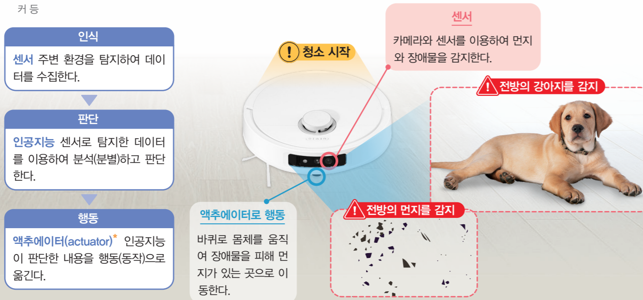
▲ [그림 1-2] 지능 에이전트인 로봇 청소기의 동작 방법 예: 인공지능이 적용된 로봇 청소기는 센서와 카메라를 이용하여 주변 환경을 스캔하고 지도를 생성한 뒤, 지도 정보와 센서의 데이터를 바탕으로 청소를 한다.
